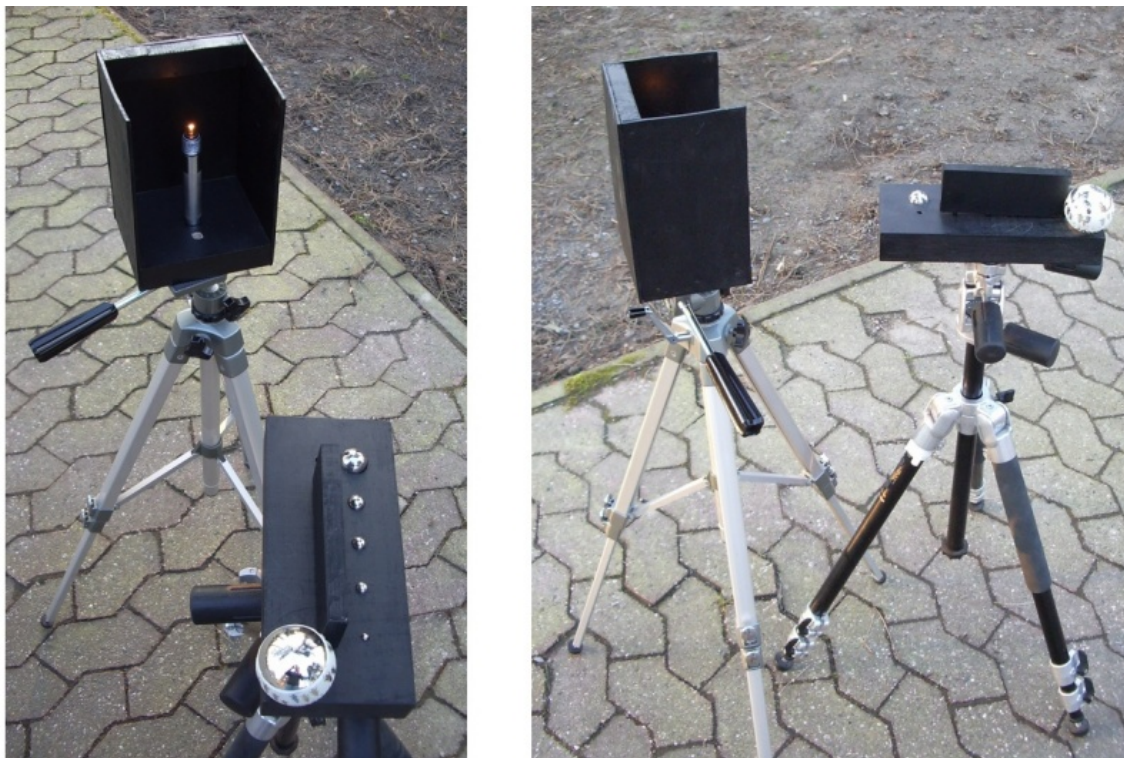
Abbildung 9: Installation für den Vergleich der Taschenlampenbirne mit der Sternhelligkeit. Die Taschenlampe steht in einem Lampenhaus, das bei der Beobachtungssituation (rechtes Teilbild) den direkten Blick auf die helle Birne versperrt. In der Nähe der Lampe befinden sich Silberkugeln verschiedener Größe, die einen Spiegelreflex der Lampe versenden, der aus einer Entfernung von einigen Metern Sternhelligkeit aufweist.
