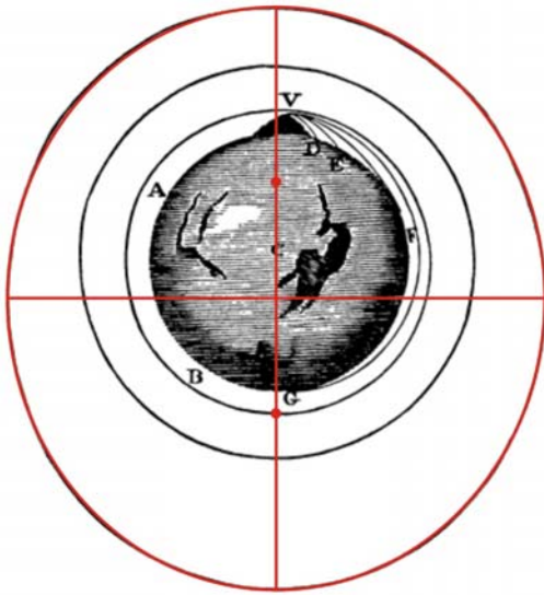
Abbildung 8: Die äußere Ellipsenbahn im Newton-Diagramm ist im Widerspruch zu den Keplerschen Gesetzen. Die Erdmitte fällt mit keinem Fokus der Ellipse zusammen (immerhin liegt sie auch nicht in der Ellipsenmitte). Weder ein natürlicher noch ein künstlicher Satellit kann auf einer solchen Bahn die Erde umfallen. Hier irrt Newton, bzw. sein Illustrator.
