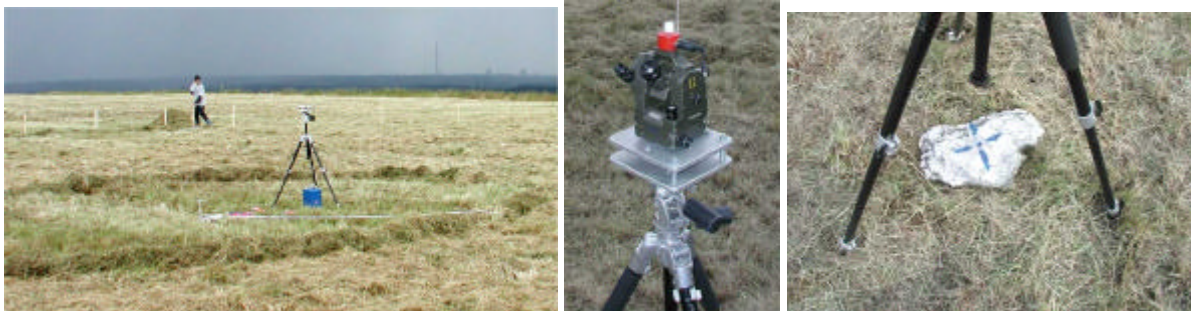
Standort des Theodolithen in der Kreismitte über einem zentralen Markierungsstein
