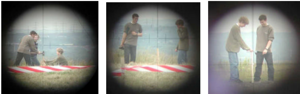
Absteckung der astronomischen Richtungen mit Holzpflocken an der Kreisperipherie, Aufnahmen durch das Fernrohr des Theodolithen
