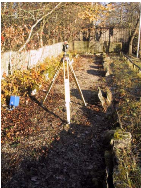
Abbildung 6: Das Galeriegrab von Soest-Hiddingsen am Tag der Messung am 10.12.2005. Der Minutentheodolit wurde auf die Mittelachse gestellt und anhand der Zeit-Sonnenazimutmethode ließ sich das Nordazimut der Achse mit einer Genauigkeit von einigen zehntel Grad zu 42,5^\circ bestimmen.
